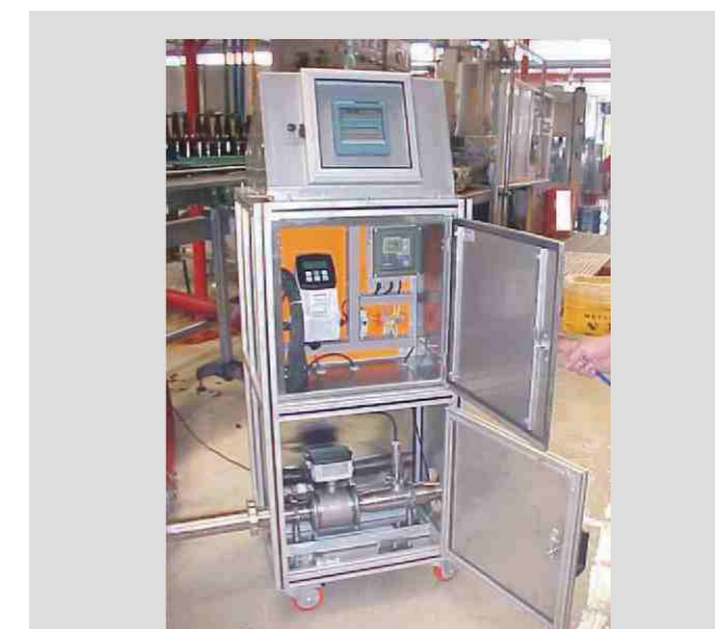
Sistema de Medição de Vazão Padrão.
